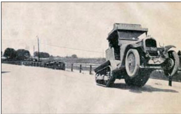
Hier maakt de Chenille 45 (gespoten in een lichte tint en hier ontdaan van zijn carbidlampen) een wheelie voordat het bijbehorende schip in beweging komt. Opvallend is het hoge bevestigingspunt aan de aak, waarschijnlijk om niet in conflict te komen met de hekken langs het kanaal?
